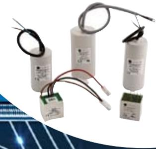
Il disgiuntore B0 è un dispositivo che collega un **condensatore di avviamento**, integrabile col dispositivo in un'unica custodia, al **condensatore di marcia** nella fase di partenza nei casi in cui viene richiesta una elevata **coppia di spunto** e lo disconnette dopo un tempo predefinito d'inserzione (standard 1").
