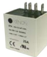
Il disgiuntore DT è un dispositivo collegato al motore con lo scopo di aumentare la **coppia di spunto** collegando una capacità (elettrolitica o a film) in parallelo a quella già presente (condensatore di marcia) sul motore.
